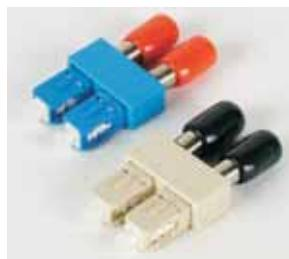
SC针式转ST孔式全双工适配器是一种可选配件，为Moxa工业以太网交换机用户提供更多的光纤连接方式。只需在任何一款Moxa工业以太网交换机的SC接口处插上这款适配器，就可以将SC接头转为ST接头。这样您就可以在Moxa任何一款工业以太网交换机上使用ST接头，而无需额外跳线。
